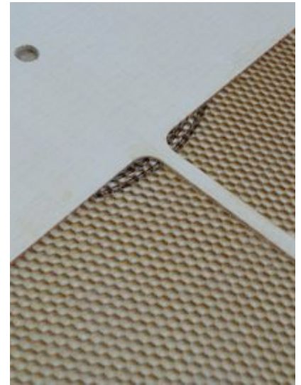
Abb. 3: Aufbau einer Decke in Sandwich-Bauweise. Bild: http://www.kirschner-gitarren.de (17.12.2010)
